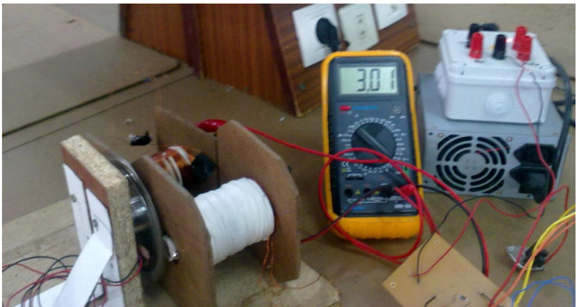
Fig.8. Experimento realizado con batería conectada al motor para su carga.
