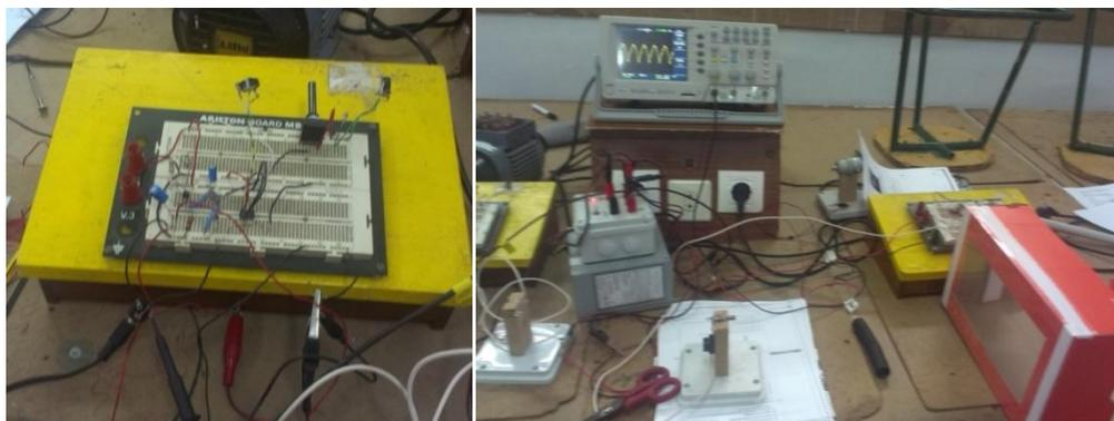
En las fotos anteriores se muestran el receptor y el emisor donde se ve como incide el laser en la ventana para reflejarlo hasta el receptor y captar las vibraciones.
